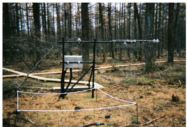
写真6. 林床に設置した微気象観測システム類
