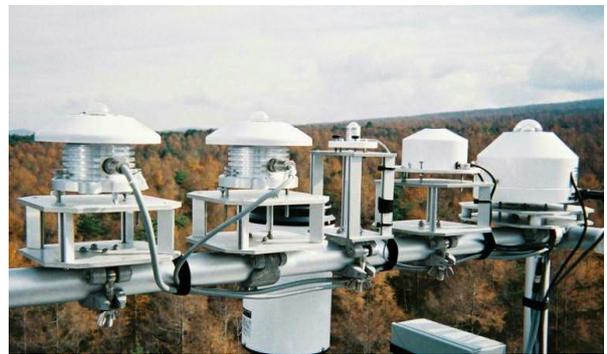
写真4. 観測塔頂部に設置した光センサー類
