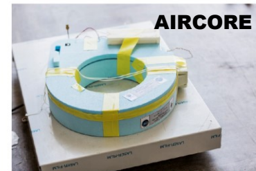
Figure 9 : Échantillonneur atmosphérique AirCore (photo : Alexandre Ollier)
