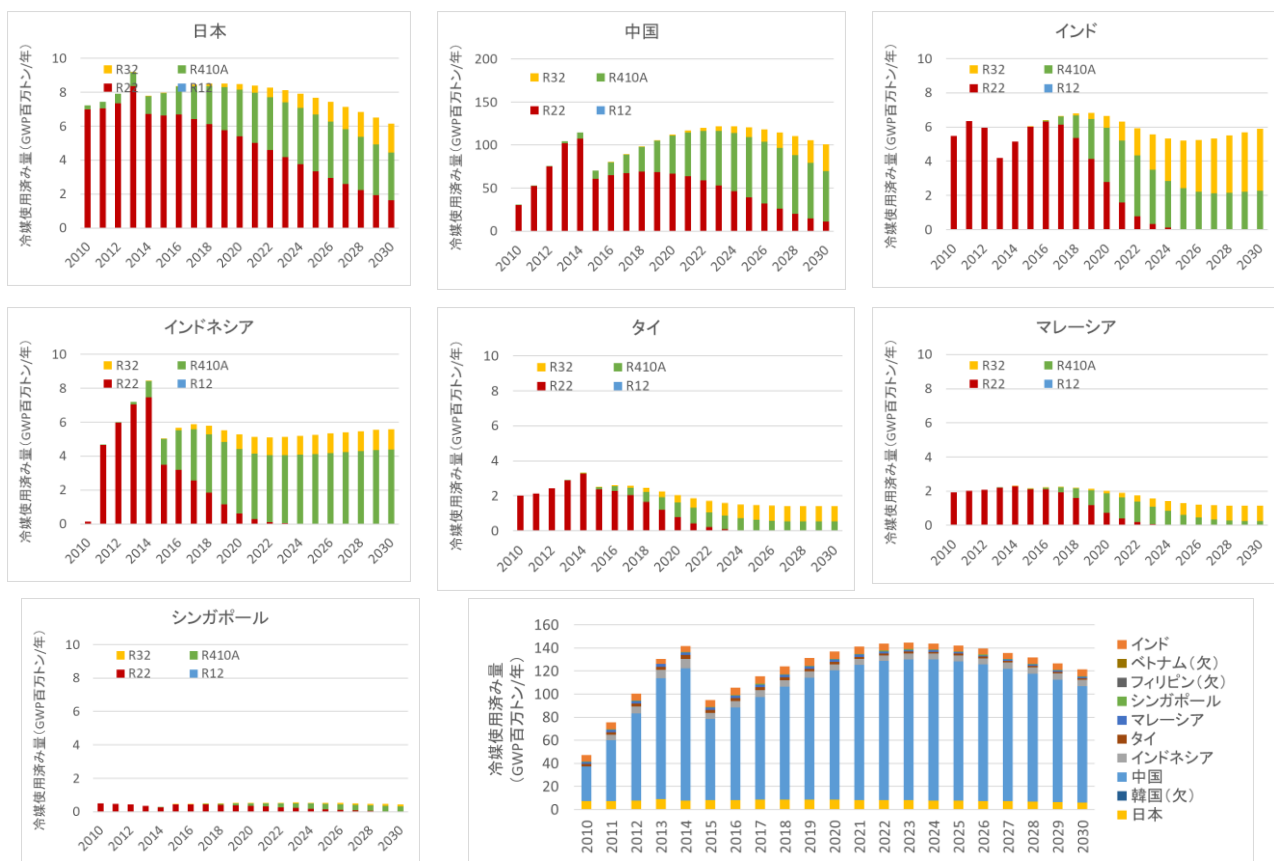
図 2.2.5 アジア諸国における使用済エアコンに含まれる冷媒フロン量（GWP 換算量）の推計結果
