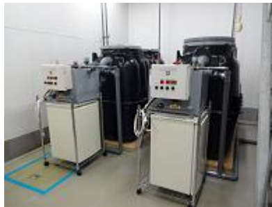
図 2.4.2 実生活排水を使用した恒温実験室（30°C）での実規模試験（国立環境研究所内）
