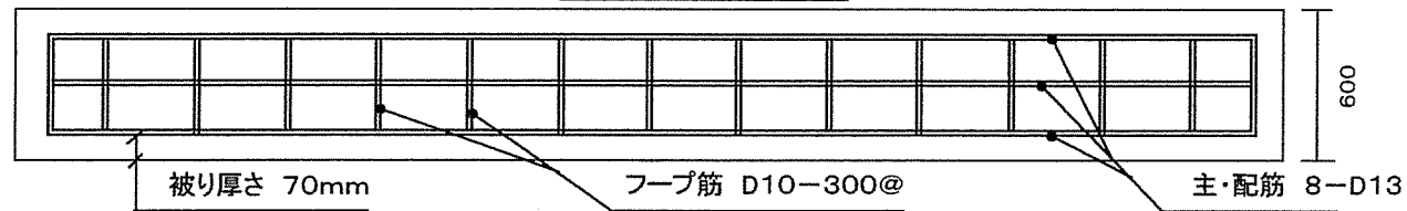
基礎部鉄筋断面図
