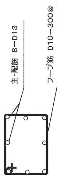
支柱部鉄筋平面図
