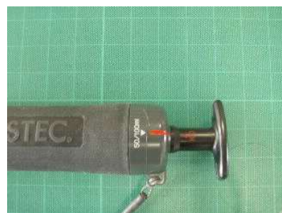
写真①-2.7 気体採取容量の ガイドマーク
