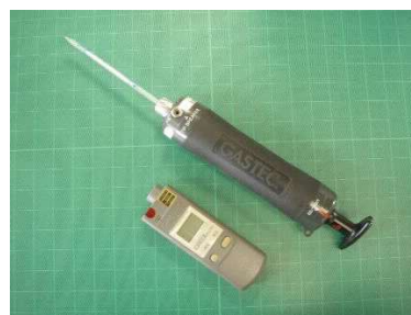
写真①-2.4 (上)ガステック気体採取器(GV-100)、 (下)硫化水素濃度指示警報計
