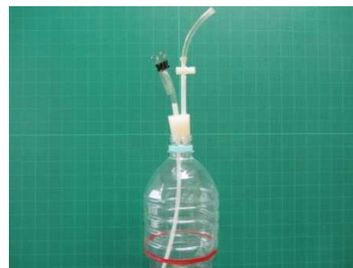
写真①-2.5 検水を入れて PETボトルを密栓
