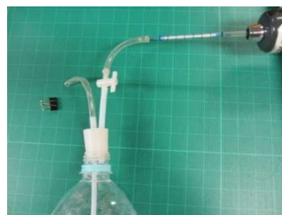
写真①-2.6 検知管をチューブに接続し、吸引
