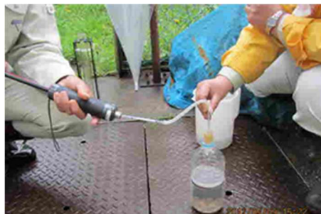
写真①-2.1 検水中の硫化物の測定
