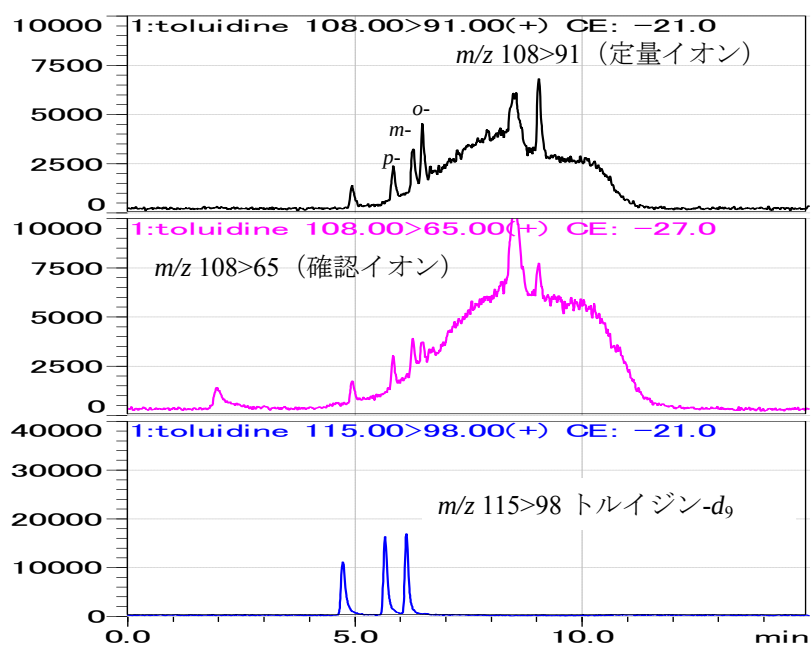
図 3-1 MDL 測定時の正イオン SRM クロマトグラム (対象物質添加量 : 0.20 ng、内標準物質濃度 : 1.0 ng/mL)
