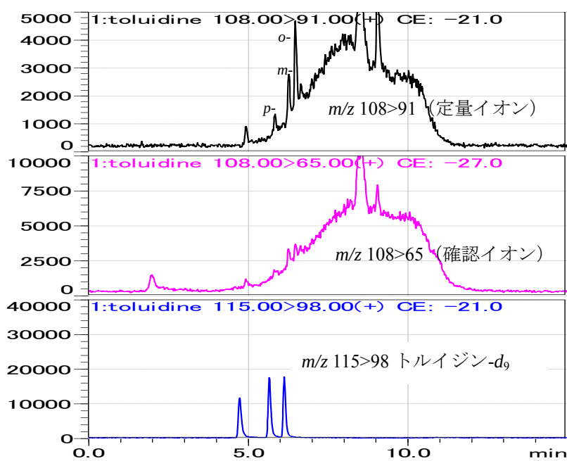
図 3-2 MDL 測定時の正イオン SRM クロマトグラム (操作ブランク) (対象物質無添加、内標準物質濃度 : 1.0 ng/mL)
