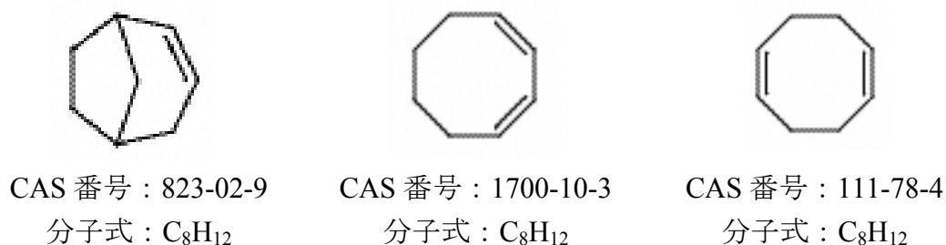
図 14 ビシクロ [3.2.1] オクタ-2-エン（左図）、1,3-シクロオクタジエン（中図）、1,5-シクロオクタジエン（右図）の構造式
