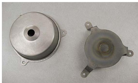
図21 セシウムイオン化装置シールド
