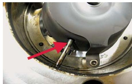
図20 セシウム供給パイプ(赤矢印)の位置調整
