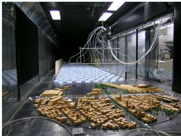
図20 大気拡散風洞の測定部
