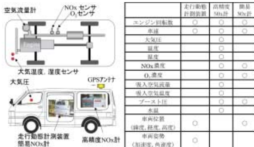
図56 計測車両の例と各種の車載計測装置と計測項目の関係
