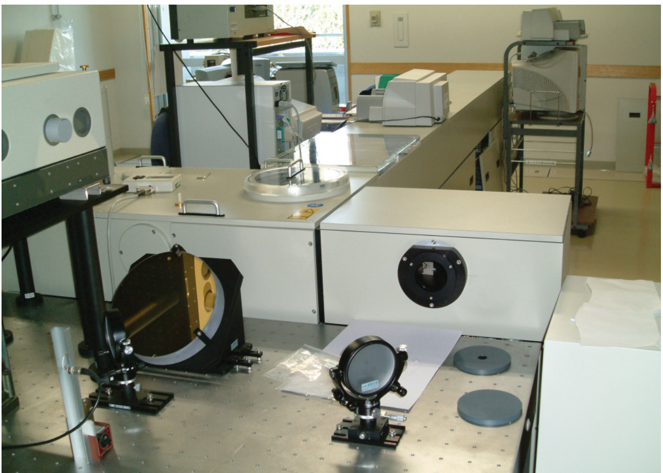
図2 大気微量成分スペクトル観測室に設置された高分解能フーリエ変換赤外分光計（FTIR）
