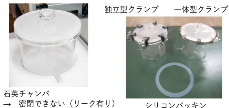
図 2.1-10 石英チャンバと蓋と本体間の固定器具
