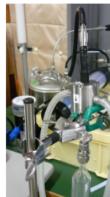
図 2.3-12 パーチャルインパクト (VI) の原理の模式図と作成した VI
