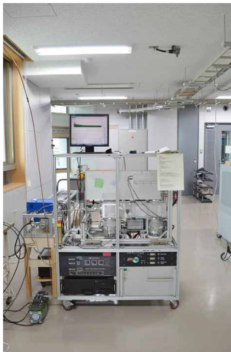
図 1 国立環境研究所大気汚染質実験棟に設置されたエアロダイン社製 ToF-AMS
