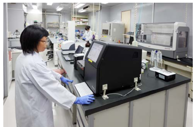
図 1 分析機器室の様子。手前は次世代シーケンサー MiSeq。この装置はヒトゲノム 5 人分の塩基配列データを 4 日間で読み取ることができます。右側は分注ロボット Biomeck4000。真ん中奥はキャビラリー型シーケンサー DNA アナライザー 3730。
