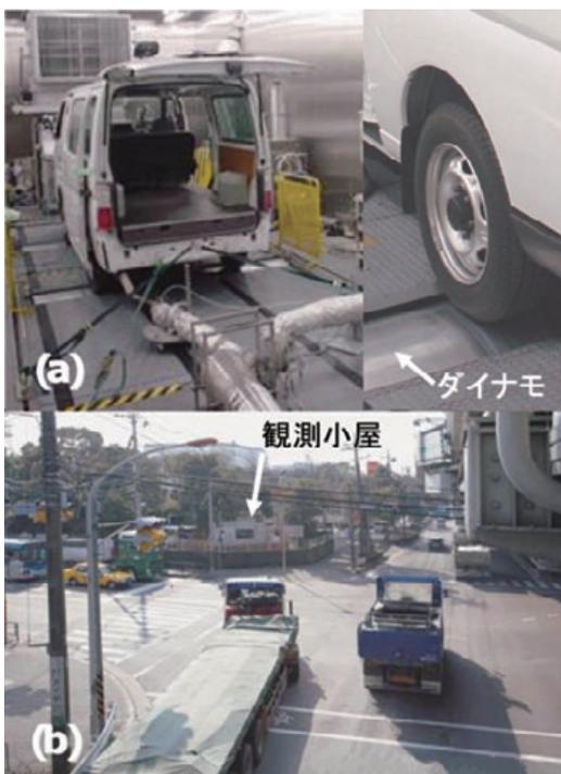
写真1 (a)シャシーダイナモメータを用いたディーゼル車試験の様子(ディーゼル車試験は、ダイナモの上に車輪を載せて行います)、(b)沿道観測地点(神奈川県「川崎臨港警察署前」交差点)。
