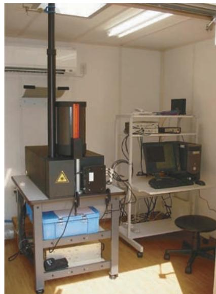
左：研究所内のライダーから夜空へ延びるレーザー光線。右：ライダーが設置された室内の様子。オレンジ色の支柱で固定されている望遠鏡で、上の天窓から入ってきた散乱光を集める。7ページからの記事を参照。
