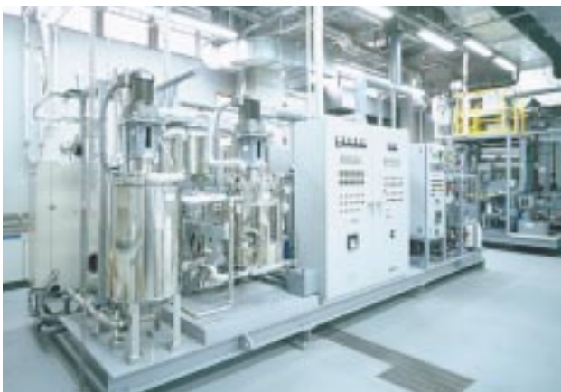
写真3 乳酸発酵・回収装置
