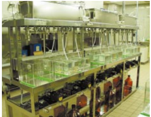
写真 2 メダカ用流水式連続曝露装置
