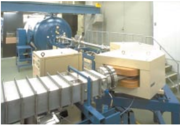
写真 加速器質量分析装置 (NIES-TERRA) の中心をなす。青色のタンク内で500万ボルトという高電位を発生しイオンを加速する。
