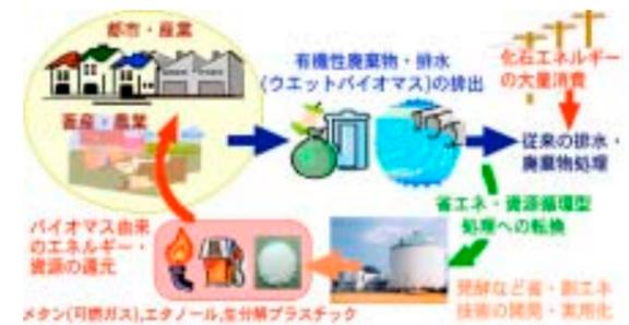
図1 ウエットバイオマスの資源循環利用（多量に排出される廃棄物や排水の省・創エネルギー型処理技術の開発と実用化により、資源循環のサイクルが構築される）
