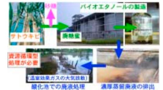
図2 砂糖製造廃液（廃糖蜜）からの燃料エタノールの製造（蒸留廃液の資源循環型処理の可否がエタノール生産技術普及の鍵となる、タイ、コンケン）
