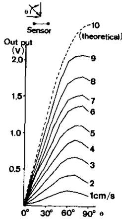
図 2-9 超音波流速計の方向特性
