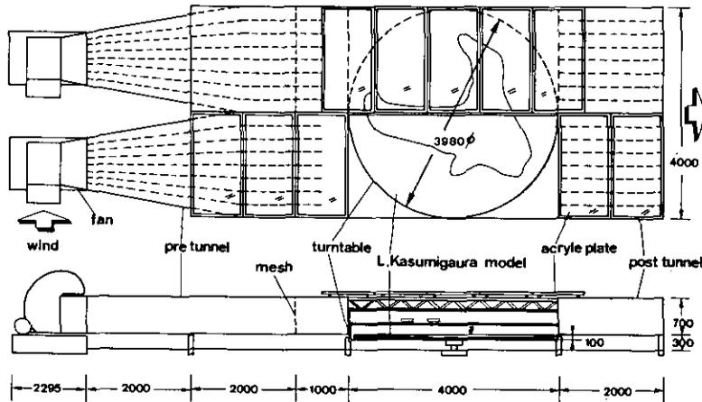
図 3-15 霞ヶ浦模型吹送流実験の装置
