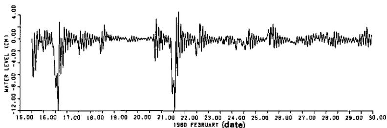
図 4-3 一層モデルによる土浦地点での水位変化シミュレーション
