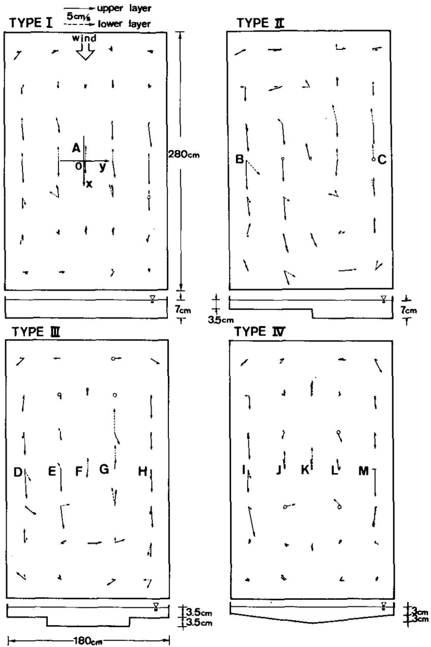
図 3-11 基本底面地形に生じる水平循環流
