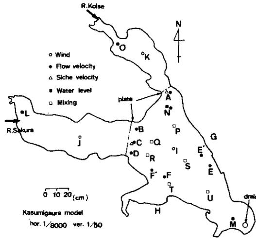
図 3-16 霞ヶ浦模型吹送流実験-測定項目
