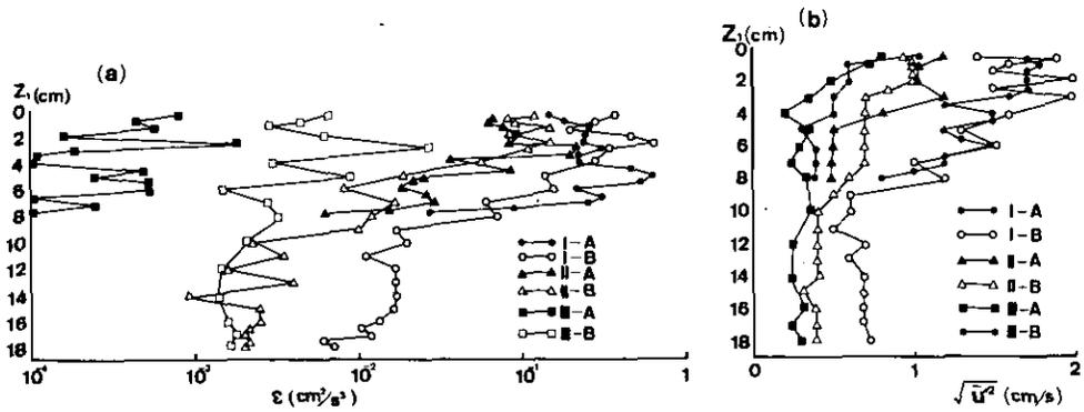
図 3-7 エネルギー逸散率(a)と乱れ速度(b)の鉛直分布特性
