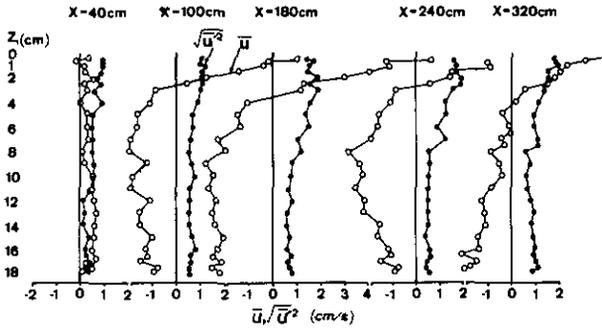
図 3-2 鉛直循環流実験  $\bar{u}$ ,  $\sqrt{u'^2}$  の鉛直分布の吹送方向変化 (Run I-B)
