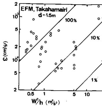
図 2-17 高浜入域での風速とエネルギー逸散率の関係 (電磁流速計)
