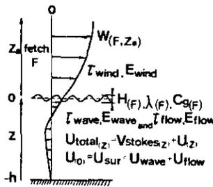
図 1-1 風から水塊への運動量、エネルギーの輸送
