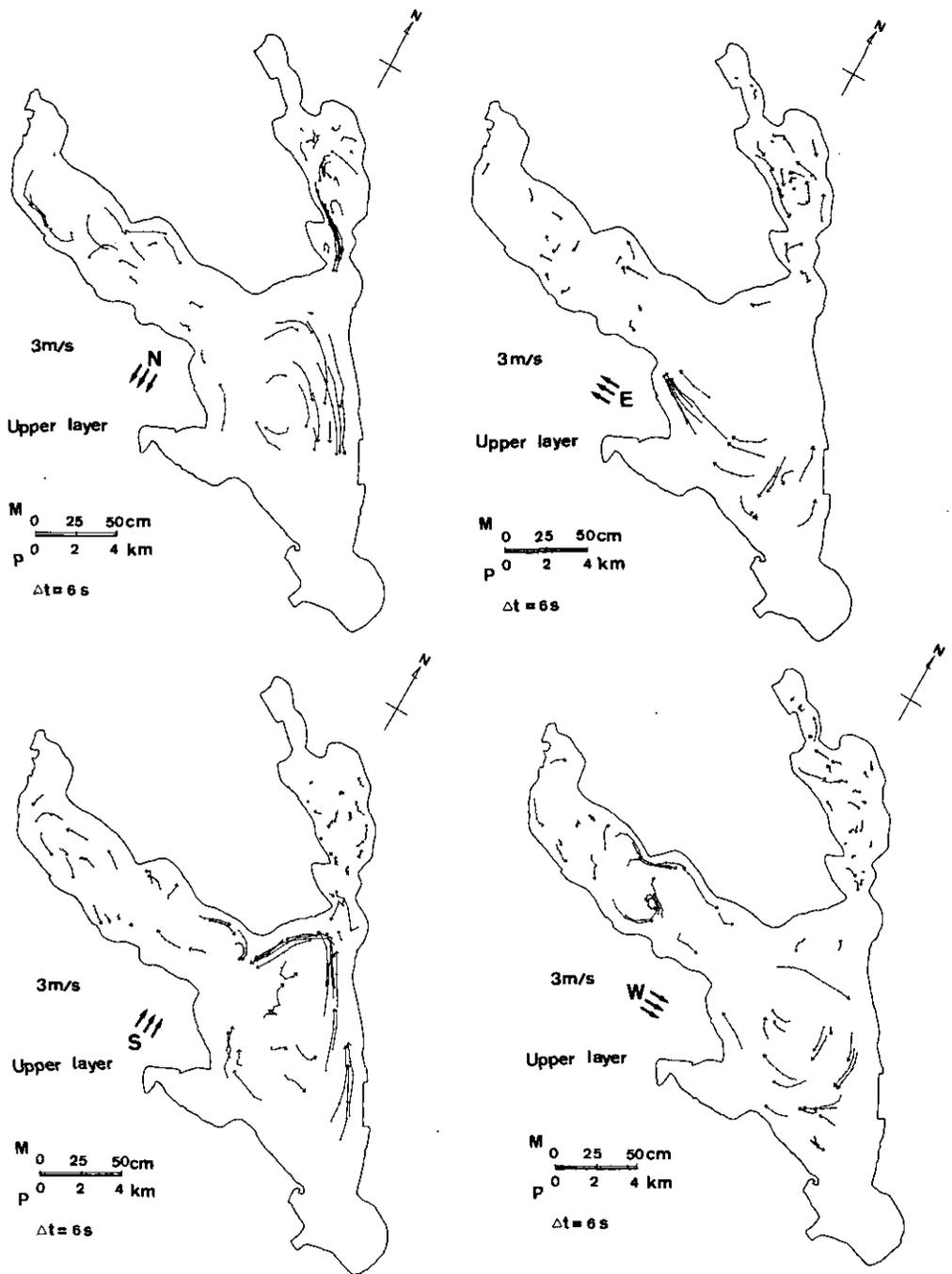
図 3-19 フロートによる流速分布測定結果 (b) 風速Ⅱ
