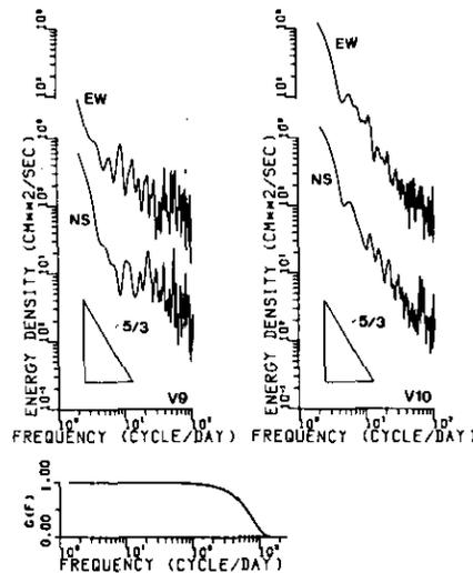
図 2-14 電磁流速計による流速変動のエネルギースペクトル (V9, V10)
