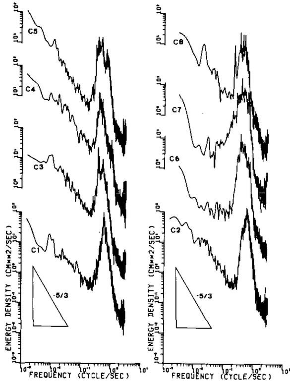
図 2-12 超音波流速計による流速変動のエネルギースペクトル
