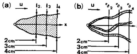
図 3-13 染料の溶け出し方—(a)乱流型、(b)層流的ゆらぎ
