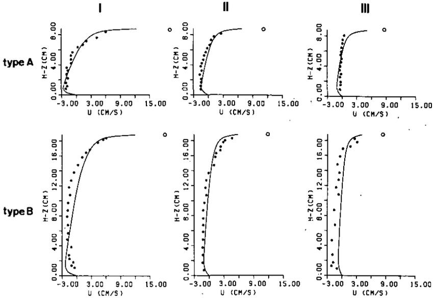
図 3-3 鉛直循環流速分布—実験結果と数値計算結果(曲線)
