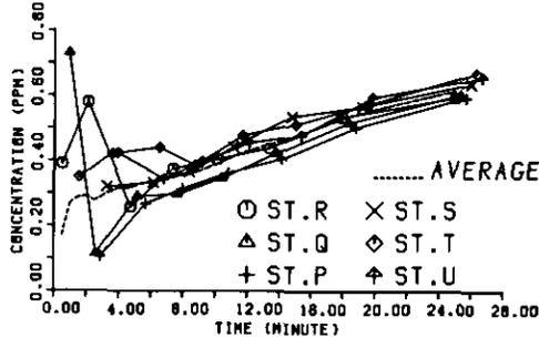
図 3-27 霞ヶ浦模型吹送流実験—混合実験結果の一例 (II, Sの風, 土浦入しきり)
