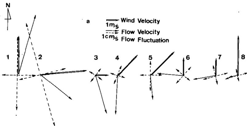
図 2-13 超音波流速計による各測定シリーズの  $\bar{u}$ ,  $\sqrt{u'^2}$  及び風向・風速
