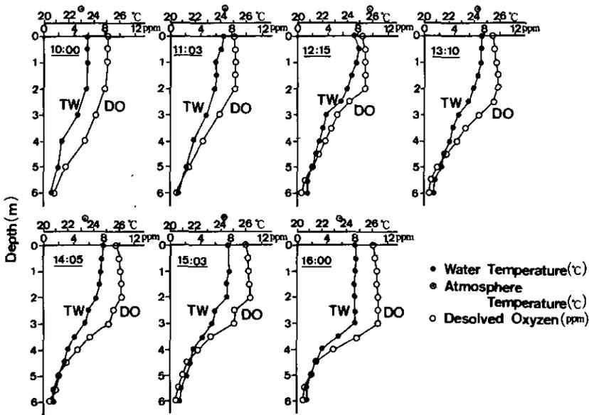
図 2-18 水温、溶存酸素量の鉛直分布の経時変化例 (1977.7.5 St.J)
