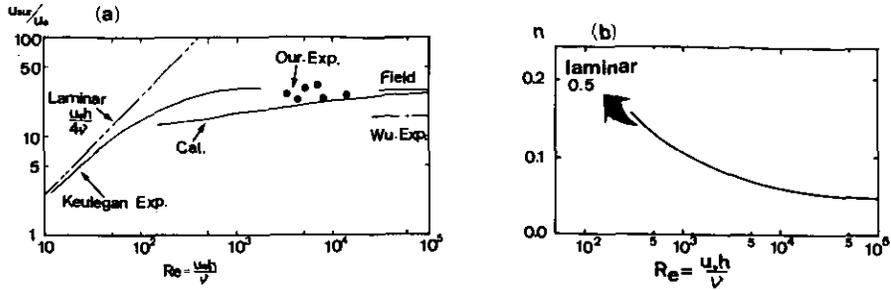
図 3-9 (a)  $u_{sur}$  の  $Re (= u_* h / \nu)$  による変化 (b)  $n$  の  $Re$  による変化
