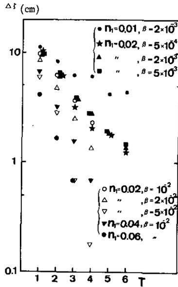
図 4-5 水位振動の減衰の速さの  $n_1$ ,  $\beta$  による変化
