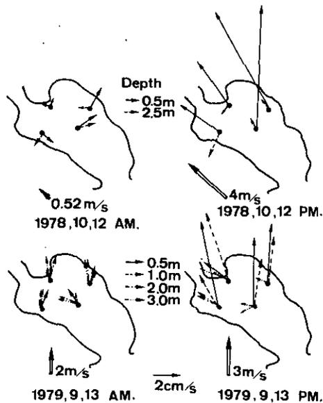
図 2-7 フロート調査により得られた高浜入での流速分布
