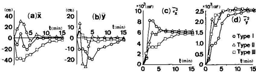
図 3-14 モデル湖における全体的混合 (a)  $x$  方向の平均位置, (b)  $y$  方向の平均位置, (c)  $x$  方向分散, (d)  $y$  方向分散
