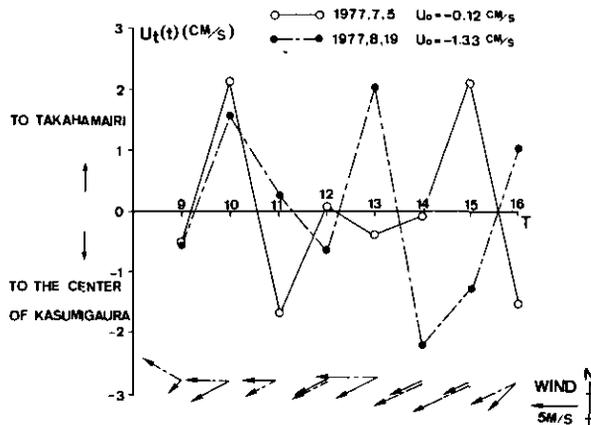
図 2-24 高浜入出口断面での流入流出量調査による  $u_t(t)$  の経時変化
