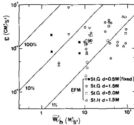
図 2-16 湖心域での風速とエネルギー逸散率の関係 (電磁流速計)
