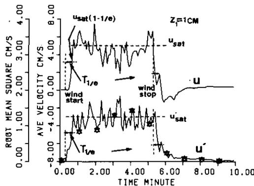
図 3-10 鉛直循環流実験-風の吹送開始、停止による  $\bar{u}$ 、 $\sqrt{u'^2}$  の変化
