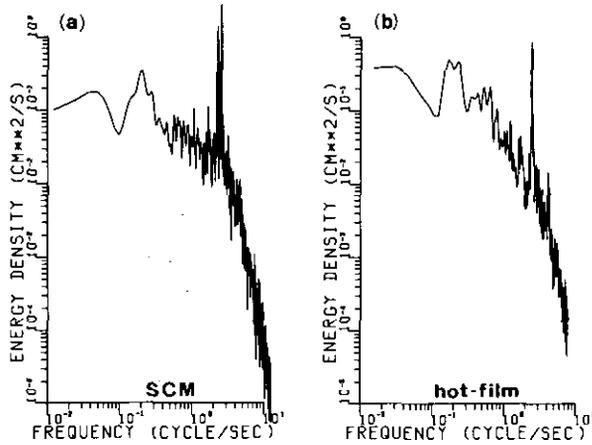
図 3-6 流速変動のエネルギースペクトル—超音波流速計(a)と熱線流速計(b)の比較
