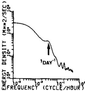
図 2-3 風速変動のスペクトル(土浦, 春, NS風)
