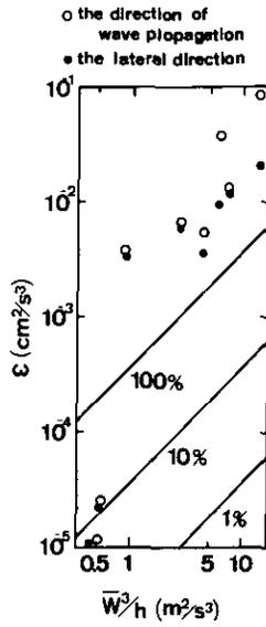
図 2-15 風速とエネルギー逸散率の関係 (超音波流速計)
