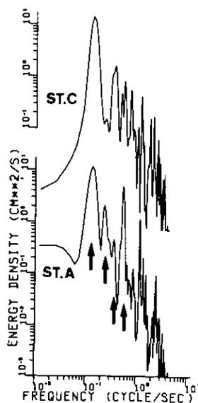
図 3-22 セイシュによる流速変動エネルギースペクトル
