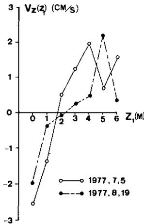
図 2-8 高浜入出口断面での流入流出量調査により得られた鉛直流速分布  $v(z_1)$
