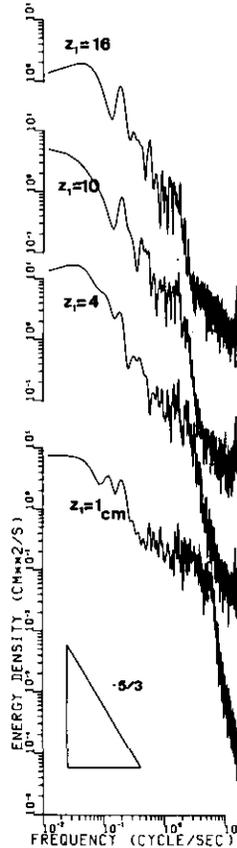
図 3-5 流速変動のエネルギースペクトルの鉛直変化
