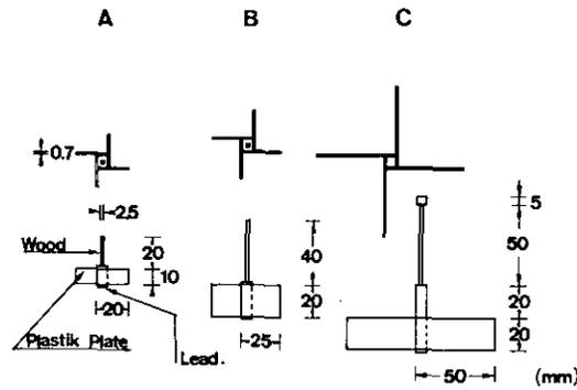
図 3-17 流速分布測定に用いたフロート
