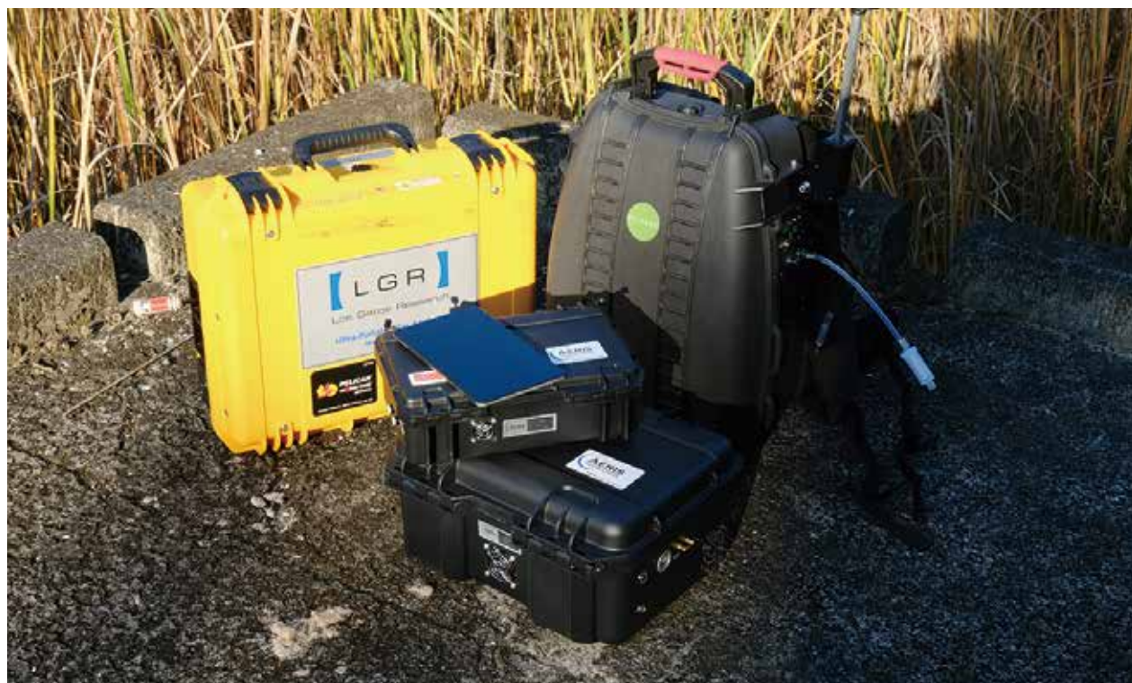
■写真3 さまざまな赤外レーザー吸収分光計 観測用途に応じて、いろいろな機器メーカーから多様な赤外レーザー吸収分光計が手に入るようになりました。2000 年台後半から、ペンチトップ型の高精度なレーザー分光計が市場に出始めましたが、その後 2010 年代には手で持てるアタッチケース型や、リュックサック型、あるいはノート PC サイズの超小型で軽量なものまで登場しました。そして現在では、本文にも記述したように、ドローンにも搭載できるモデルが開発されています。このような観測機器の登場により、新しい観測手法が開発されるなど、現場での観測研究が進展しています。
