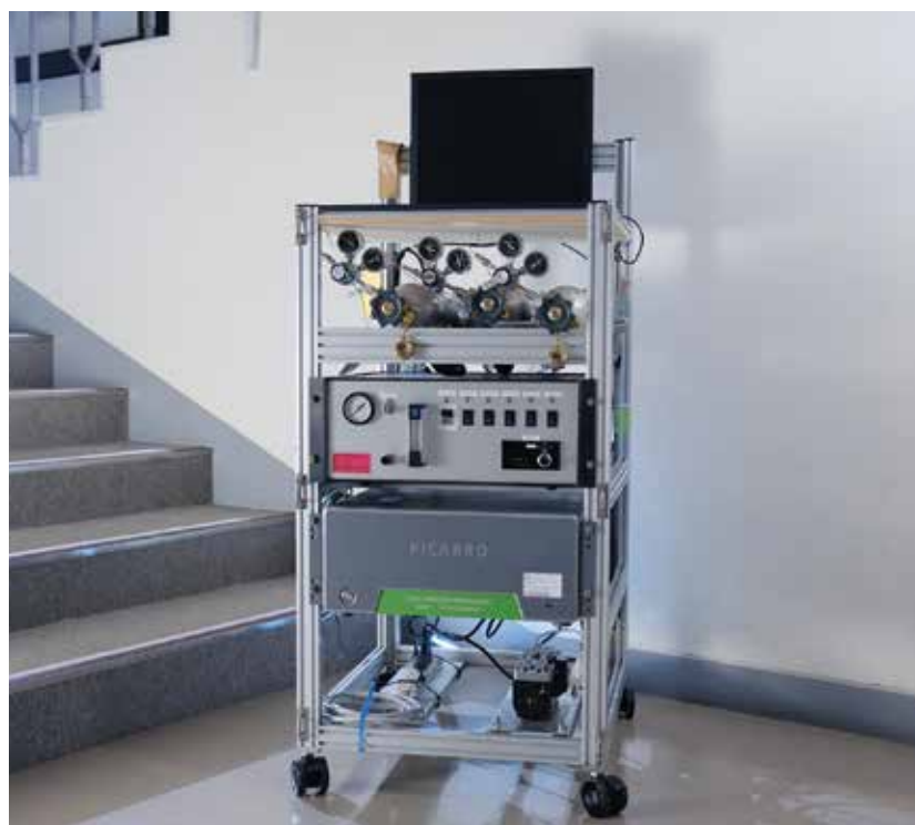
■写真 1B 実際の船舶観測で用いられている赤外レーザー吸収分光計を用いた観測システム
