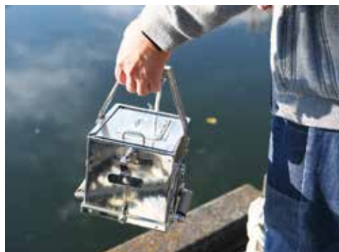
■ 図2 (左) プランクトン・ネクトン・ベントスの図 (右) エクマン・バージ採泥器
