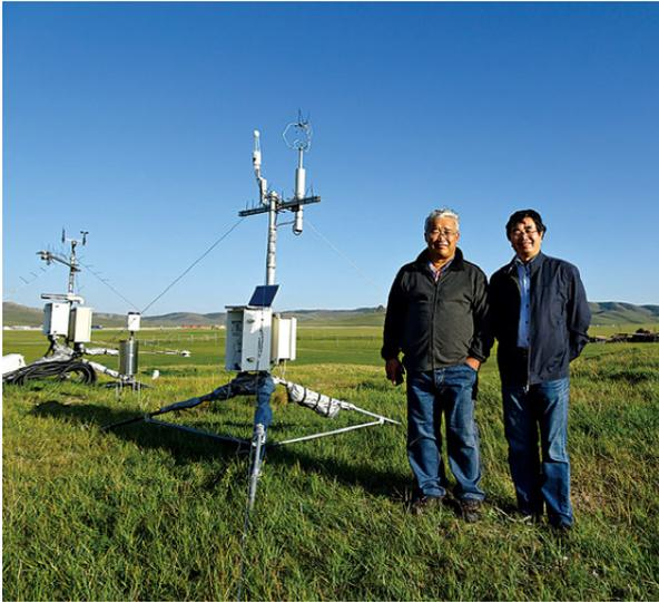
■写真2 モンゴルの草原に設置した永久凍土・CO<sub>2</sub>フラックスの観測システム
