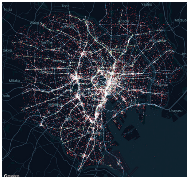
■ 図2 スマートフォンから取得した東京都23区における通勤時間帯（午前9時台）のGPSデータの分布 白くなっている箇所はGPSの密度が高い場所を表す。鉄道路線上にデータが集中していることがわかる。
