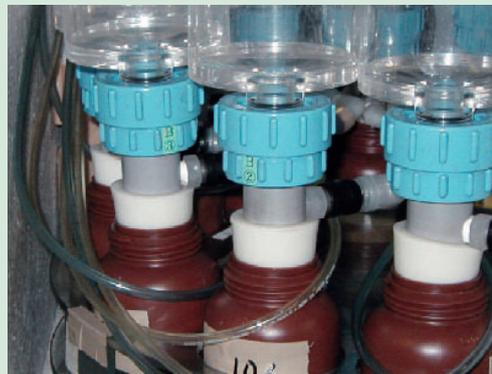
写真5 自動ろ過サンプリング装置の内部。航走しながら海水を採取して冷蔵保存し、翌朝、ろ紙(青色部分にセット)とろ過海水(サンプル瓶)を回収して、それぞれ植物プランクトン色素(クロロフィルなど)とN、P、Si各栄養塩を分析します。
