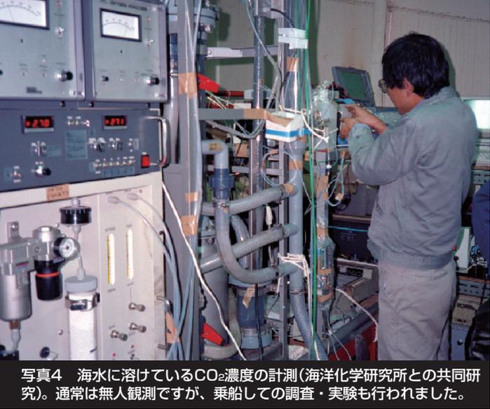
写真4 海水に溶けているCO<sub>2</sub>濃度の計測(海洋化学研究所との共同研究)。通常は無人観測ですが、乗船しての調査・実験も行われました。
