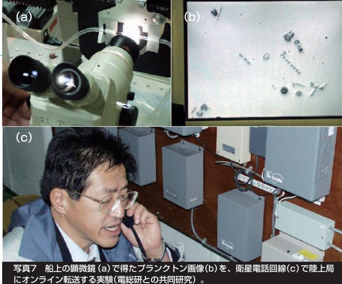
写真7 船上の顕微鏡(a)で得たプランクトン画像(b)を、衛星電話回線(c)で陸上局にオンライン転送する実験(電総研との共同研究)。
