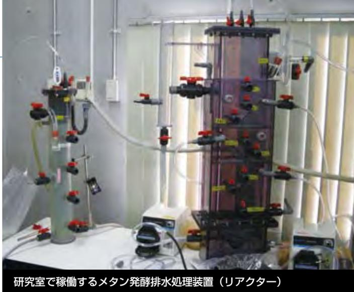
研究室で稼働するメタン発酵排水処理装置 (リアクター)
