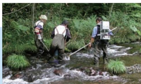
●北海道での現地調査の様子。背中に背負っているのが、魚を捕獲するための電気ショッカー。
