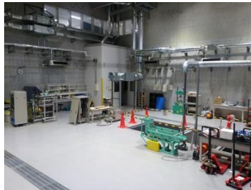
資源循環・廃棄物処理実証実験室(約150m 2 ) 放射性物質を含む廃棄物や除去土壌の減容化、中間貯蔵、最終処分などの技術開発・実証実験を行います。ライシメータや回転式電気炉があります。
