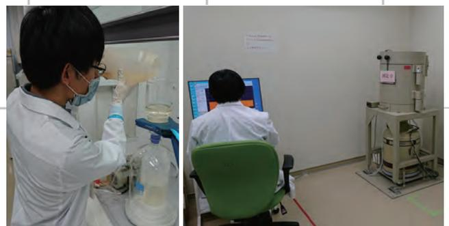
写真：ろ過操作（左）と放射能測定（右）
