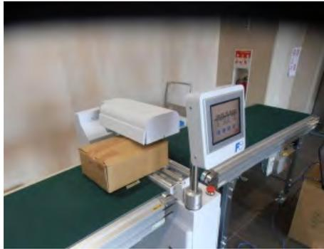
コンベア式測定器（コンベアモード）
