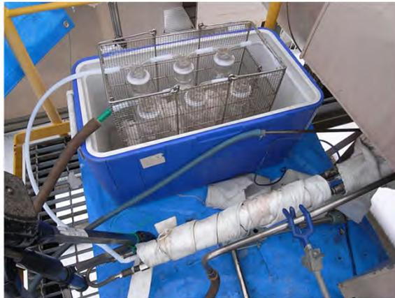
排ガス採取用の試料採取器具
