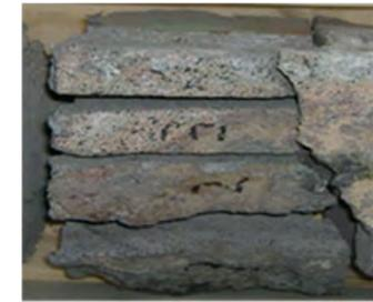
耐火物の前処理方法および耐火物切断試料の例
