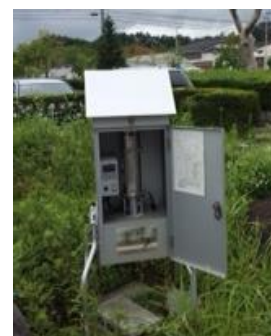
写真 空気を捕集する「ハイボリュームエアサンプラー」という装置
