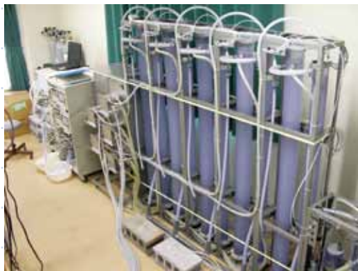
図 1 海洋生物飼育実験のために海水二酸化炭素濃度を精密に調整する装置
