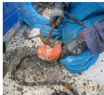
図 21 海生生物の除去作業
