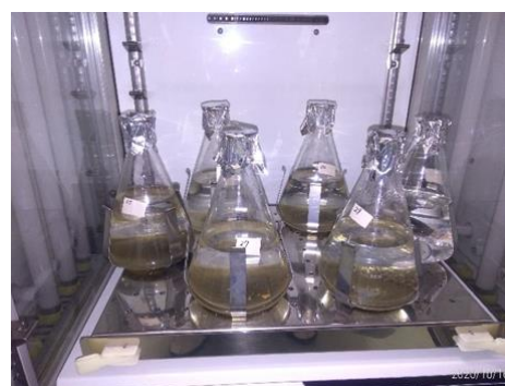
図2 底質からの DIN 遊離実験操作手順及び実験中の試料（ガラス器具は 180℃、2 時間の乾熱滅菌を実施後使用し、海水のろ過除菌にはオートクレーブ済みのニトロセルロースフィルター（孔径 0.2 μm）を使用した。）
