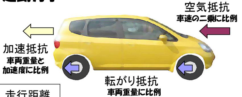
$$\text{必要なエネルギー} = \text{作用する力} \times \text{走行距離}$$
