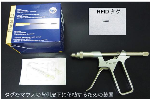
タグをマウスの背側皮下に移植するための装置
