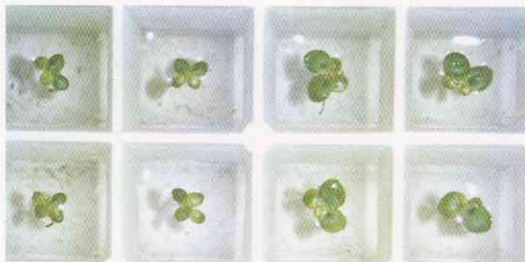
「河川水導入・流水式水槽（仕切は水面）～ウキクサ」を用いたバイオモニタリング（連続照明，水温調整）
