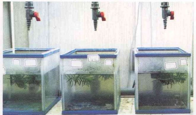
桜川の河川水を導入した流水式水槽（照明・水温調整） —ヌカエビ，魚，シジミ，水草等を連続暴露—
