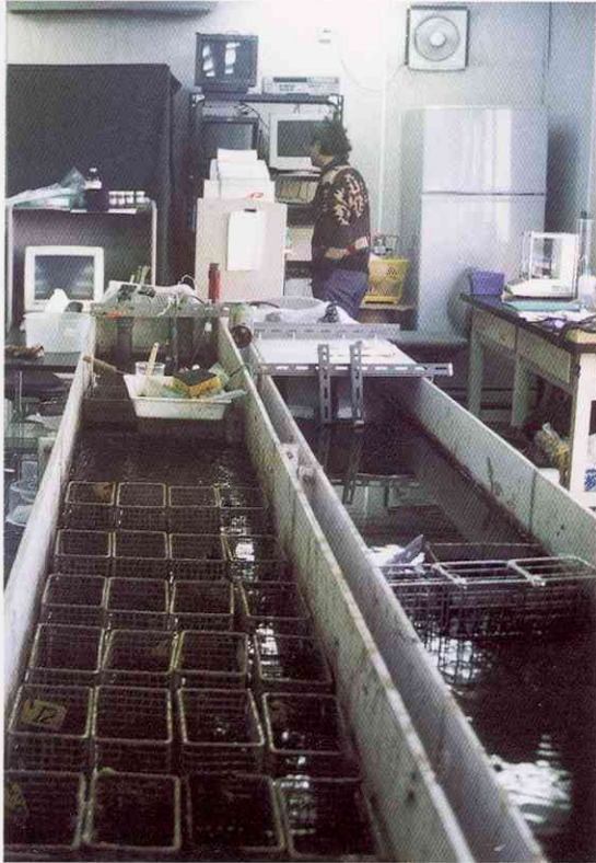
バイオモニタリング施設内に設置した河川水導入水路 後方、暗幕内はヌカエビ画像解析装置
