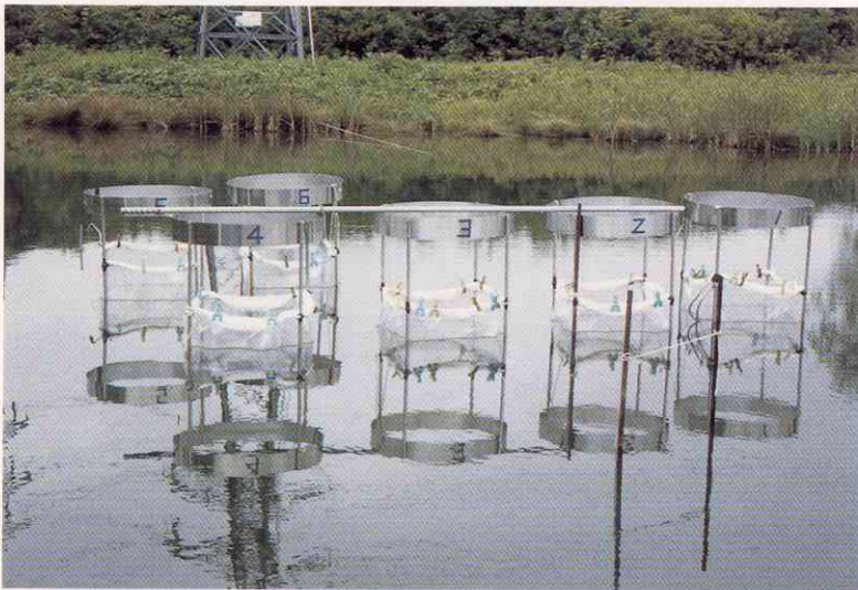
写真2 小型隔離水界-円筒型（直径1 m，深さ4 m）
