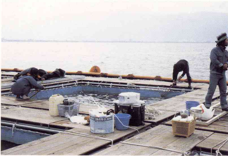
写真1 大型隔離水界（縦5 m，横5 m，深さ4 m）
