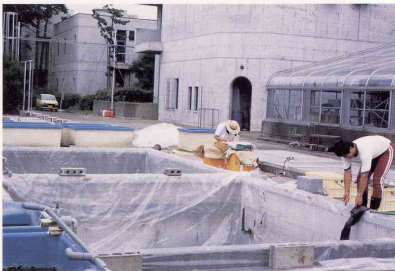
写真4 陸上型隔離水界 (大型コンクリート水槽: 縦4.1m, 横5.1m, 深さ1.5m: 実験準備)
