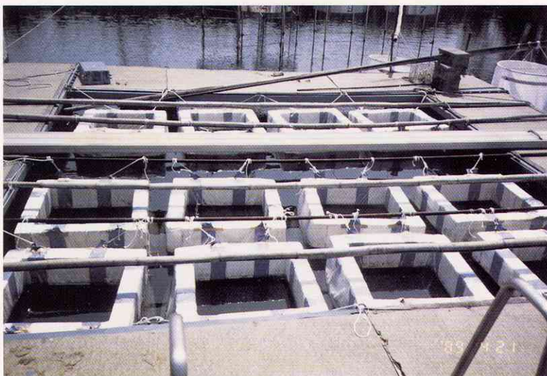
写真3 小型隔離水界-バッグ型 (直径1 m, 深さ2~3 m)
