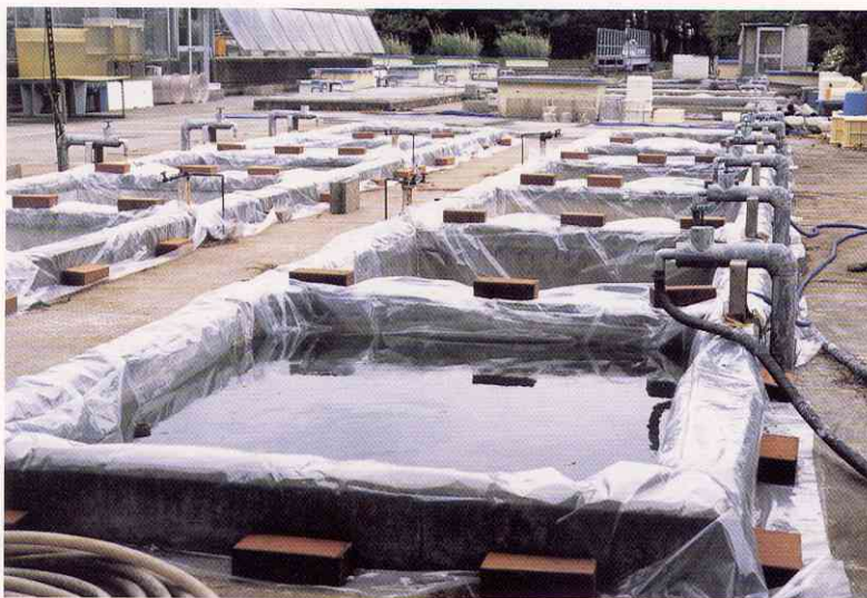
写真5 陸上型隔離水界（小型コンクリート水槽：縦1.5m，横2m，深さ0.5m）
