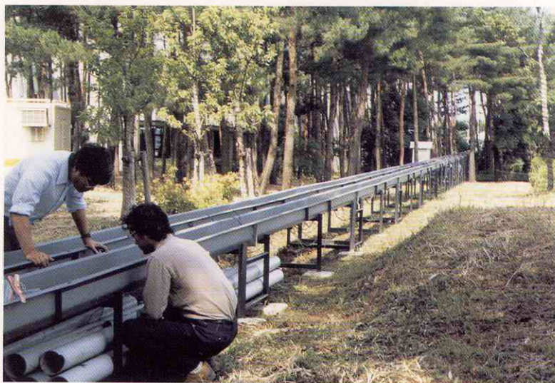
写真6 人工水路（幅25cm，長さ160m）
