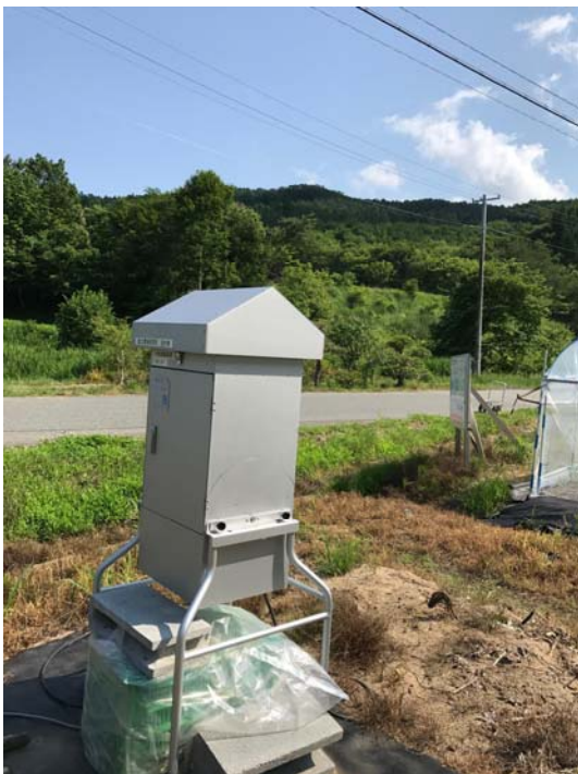
図2 飯舘村に設置したハイボリュームエアサンプラー 大気中に浮遊している粉じんを集める装置です。
