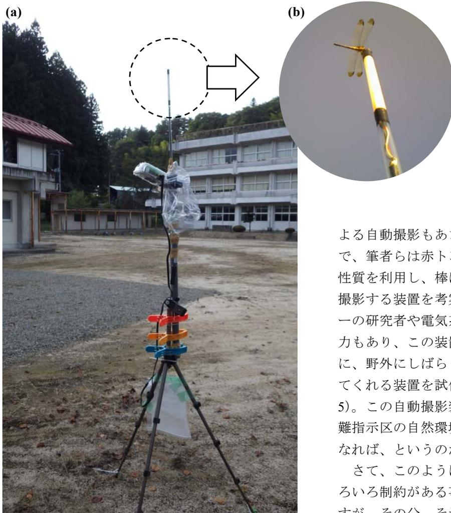
図5 (a)野外で稼働試験をしているトンボの自動撮影装置。先端にトンボが止まった場合、(b)のような形で撮影される
