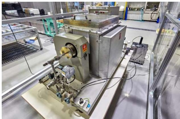
図3 小型回転式電気炉
