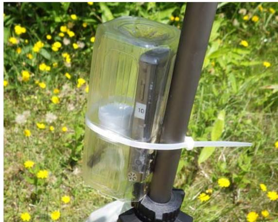
図2 ペットボトルで養生されたICレコーダー
