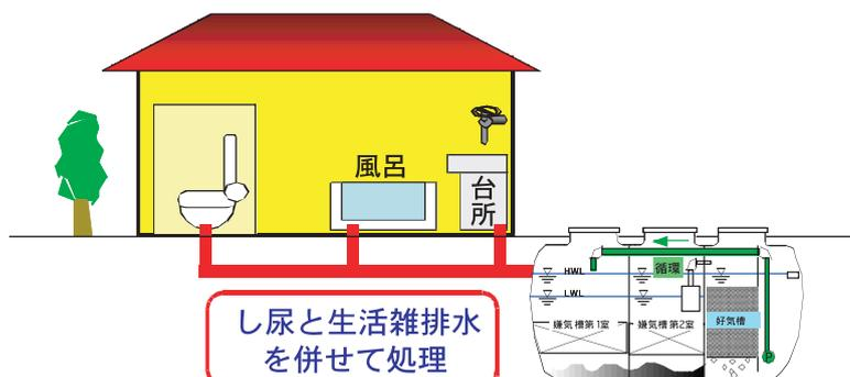
図2 し尿と生活雑排水を併せて処理する浄化槽
