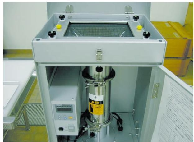
図2 波照間モニタリングステーション屋上のHVサンプラーとその内部構造
