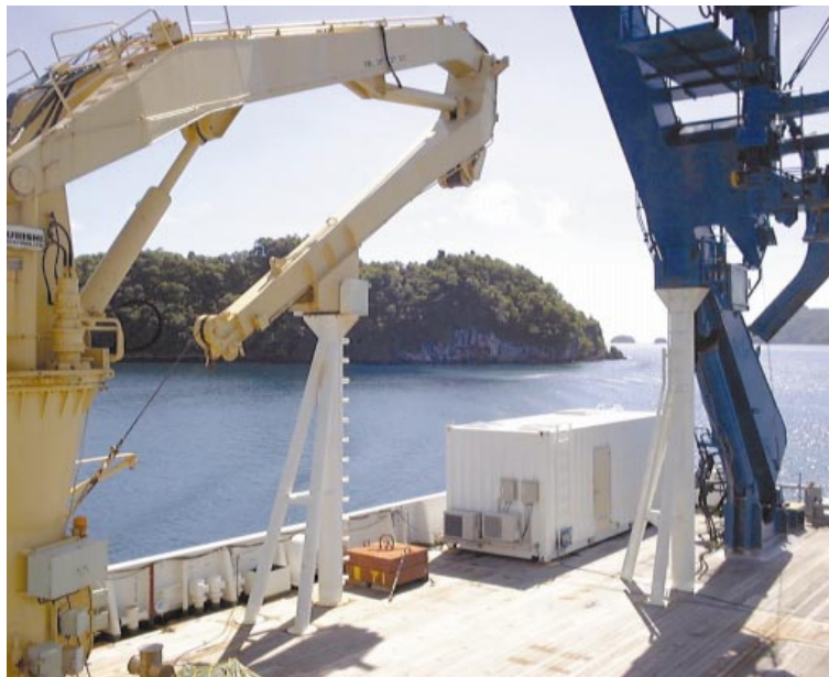
写真 「みらい」後部甲板の様子 白いコンテナの中にライダーが設置されている。
