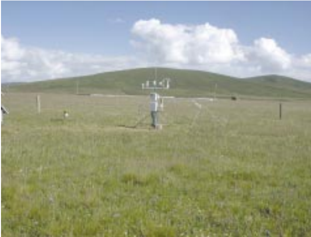
写真 青海省海北草原に設置した二酸化炭素フラックス観測システム（左）と測定風景（右）
