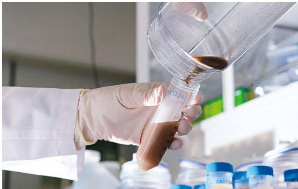
■写真2 降雨時に採取した河川水から懸濁物質を回収し(左)、放射能測定用試料を作成(右)
