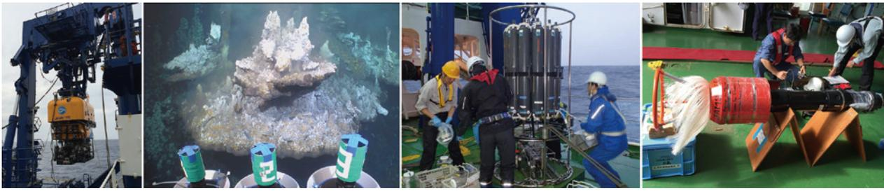
調査風景：左から深海調査用 ROV（遠隔操作型無人潜水機）、熱水噴出孔、ロゼット型採水器、投下式乱流観測装置
