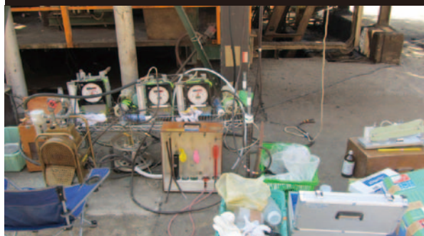
アスファルトコンクリート工場における 排ガス中セシウム測定状況
