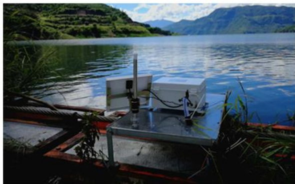
水温监测野外布置照片及其监测数据
